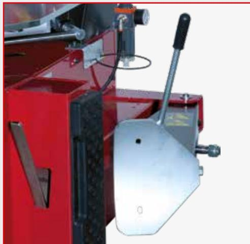
Le **détalonneur, de grande puissance** est actionné par un vérin (**D.186 mm**) à double effet, avec corps embouti en **acier INOX**. La palette du détalonner peut être équipée, sur demande, de une protectionplastique, pour sauvegarder les jantes en aluminium.
