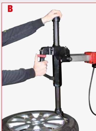
Bloqueo neumático **simultáneo** del brazo horizontal y del vertical porta torre con posicionamiento automático de la última en la posición de trabajo ideal. Automático (A) y Manual (B)
