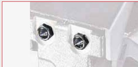
**Soportes deslizantes** con puntales de bloqueo intercambiables. Garras de fundición más altas para bloquear mejor la llanta desde el interior y exterior.
