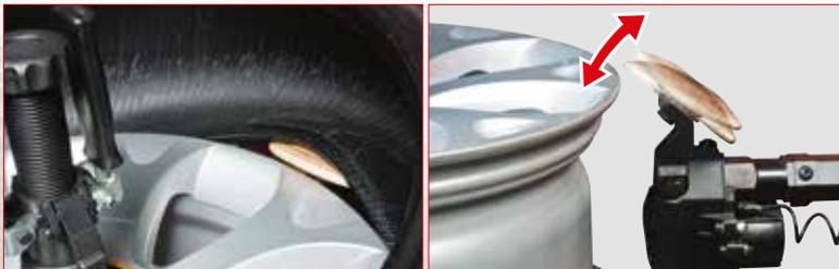
**Procedimento de desmontagem rápida** do segundo talão possibilitado pelo **movimento patenteado do disco**, particularmente adequado para pneus com flancos rígidos.
