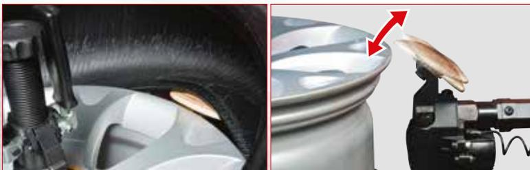
**Schnelle Demontage** des unteren Wulsts durch die **patentierte Bewegung der Abdrückscheibe**, die besonders für Reifen mit harten Flanken geeignet ist.
