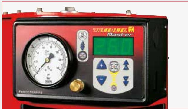
Afficheur qui permet d'introduire électroniquement le diamètre de la jante avec positionnement de tous les outils de travail, de lire la pression à l'intérieur de la roue pendant le cycle de gonflage et de sélectionner la procédure de travail avec **système PAX**.
