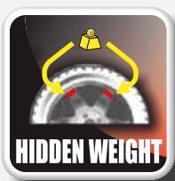
Perfecta estética de la llanta porque permite dividir el peso adhesivo de equilibrado del flanco externo en dos pesos equivalentes colocados en una posición oculta detrás de los radios.
