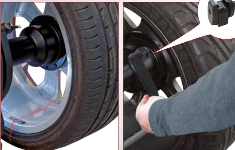
Os contrapesos adesivos podem ser aplicados com muita rapidez, utilizando o **apontador laser** na **posição 6 horas** (laser line system) ou através da utilização do **clipe** porta-pesos ou **manualmente** na **posição 12 horas**.
