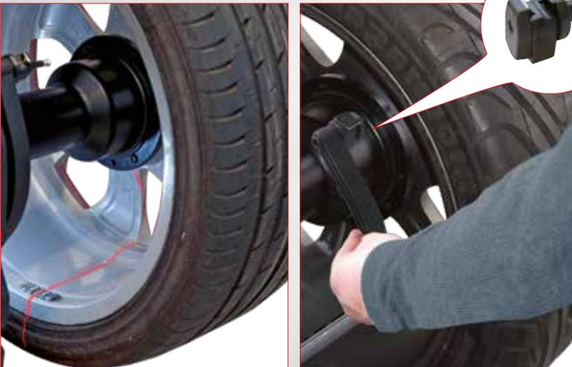
Los contrapesos adhesivos pueden ser colocados con extrema velocidad utilizando el puntero láser en la **posición de las 6 horas** (laser line system) o mediante el **uso del clip portapesos** o **manualmente en la posición de las 12 horas**.
