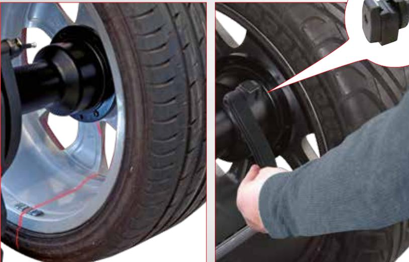
I contrappesi adesivi possono essere applicati con estrema velocità utilizzando il puntatore laser a **ore 6** (laser line system) o tramite l'utilizzo della **clip portapesi** oppure **manualmente a ore 12**.
