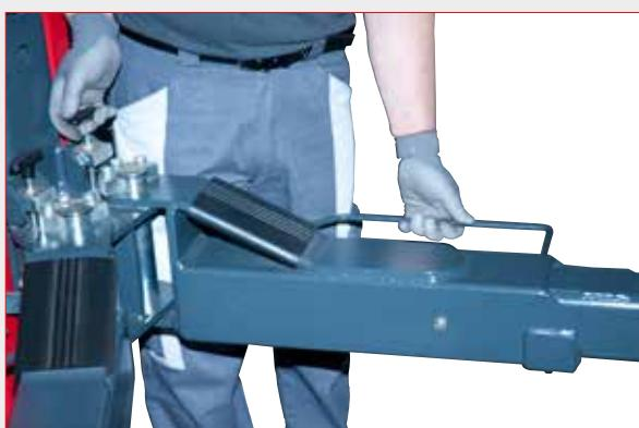
Le dispositif de blocage automatique de la rotation des bras se déclenche dès la montée, mais peut être annulé en intervenant sur les boutons en correspondance du point de rotation.
