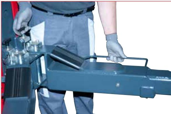
Il sistema di bloccaggio automatico della rotazione dei bracci interviene non appena inizia l'operazione di salita, ma può essere sbloccato all'occorrenza dall'operatore agendo sugli appositi comandi in corrispondenza del fulcro di rotazione
