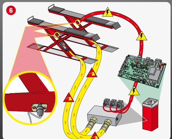
**6** Sistema di livellamento idraulico a controllo elettronico. **6** Electronically controlled hydraulic levelling system. **6** Dispositif de géométrie hydraulique à contrôle électronique. **6** Hydraulisches Nivelliersystem mit elektronischer Steuerung. **6** Sistema de nivelación hidráulica de control electrónico. **6** Sistema de nivelamento hidráulico de controlo electrónico.
