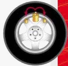
Programa Peso Escondido “Hidden Weight” (em Alu P) para dividir o peso adesivo de equilibragem da lateral externa em **dois pesos equivalentes** colocados atrás dos raios da jante.
