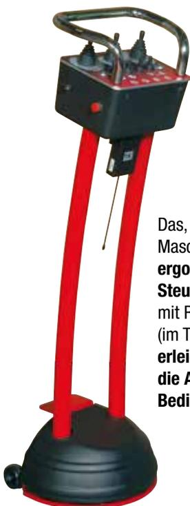
Das, von der Maschine getrennte, ergonomische Steuerpult mit Rädern (im Trolley-Stil) erleichtert die Arbeit des Bedieners.
