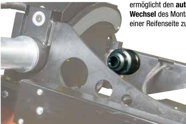
Das **S.T.S. (Side To Side)** System ermöglicht den **automatischen Wechsel** des Montagekopfs von einer Reifenseite zur anderen
