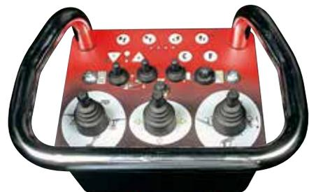
Mit dem **neuen Steuerpult** mit **ergonomischen Bedienelementen** können alle Arbeiten ausgeführt werden, ohne dass der Bediener **mit den Werkzeugen in Berührung kommt.**
