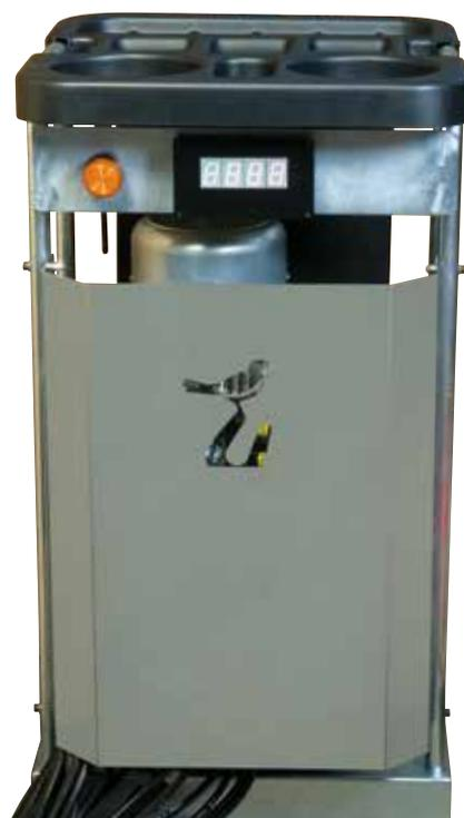
Das elektro-hydraulische Steuergerät mit Display lässt sich nach Belieben positionieren und ermöglicht das Speichern aller Daten über den Reifen, an dem gerade gearbeitet wird.
