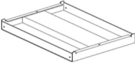
x2 | <b>Kit chiusura incavo 450 mm, 2 pz.</b> verniciati a polvere. Necessario quando non si usano piatti rotanti.                                                                 | 8-42120034 | -          | -              | -                   | 0             | 0                |
