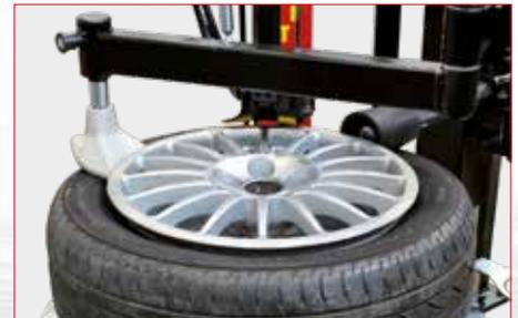
Folgt dem Reifen während der Montage- und Demontearbeiten radial mit Hilfe der Wulstniederhalterrolle oder alternativ dazu der WDK-Scheibe.
