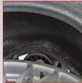
Die **GROSSE SCHEIBE** gestattet das Anheben des Reifens und das Lösen des unteren Wulsts.
