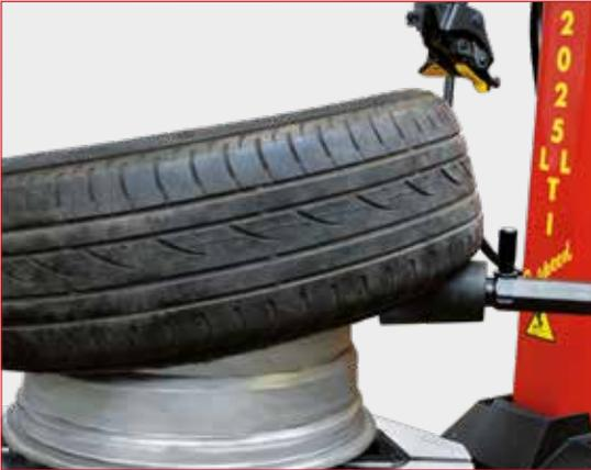
**KEGELROLLE.** Vereinfacht die Arbeiten für die Demontage und Montage des ersten Wulsts, indem der Wulst im Felgenbett gehalten wird.
