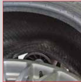
Le **GRAND DISQUE** permet de soulever le pneu et de détacher le talon inférieur.
