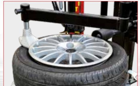
Il suit radialement le pneu dans les opérations de montage et de démontage, à l'aide du rouleau presse-talon ou du disque WDK
