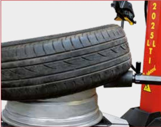
**RULLO CONICO.** Facilita le operazioni di smontaggio e montaggio primo tallone, mantenendo il tallone nel canale del cerchio. **Agevola la fase di smontaggio del secondo tallone.**
