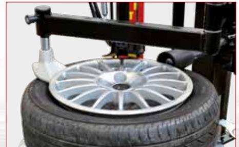
Segue radialmente il pneumatico nelle operazioni di montaggio e smontaggio, con l'ausilio del rullo premitallone o in alternativa del disco WDK.
