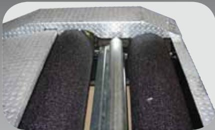
Rulli sfalsati - L'offset verticale dei rulli ottimizza le misure di forza frenante, evitando la fuoriuscita della ruota dai rulli durante la frenata • *Staggered rollers - The vertical offset of the rollers optimises the measurements of the braking force, preventing the wheel protruding from the rollers during braking*
