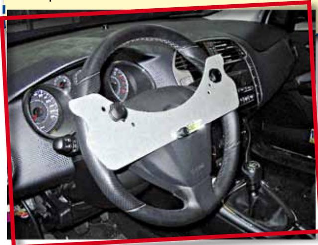
In der Standardausführung wird der **Cal One-Touch** mit einem USB-Kabel an den Computer des Achsmessgerätes angeschlossen. Beweglichkeit, Flexibilität und Arbeitskomfort durch drahtlose Kommunikation mit Bluetooth™ (optional), die Stromversorgung über das Portal EOBD2 benötigt keine Batterien.
