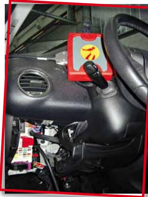
Kommunikationsmodul mit den Steuerungselektroniken des Fahrzeugs. Der Anschluss erfolgt über das Portal EOBD2, über das das Modul auch gespeist wird.
