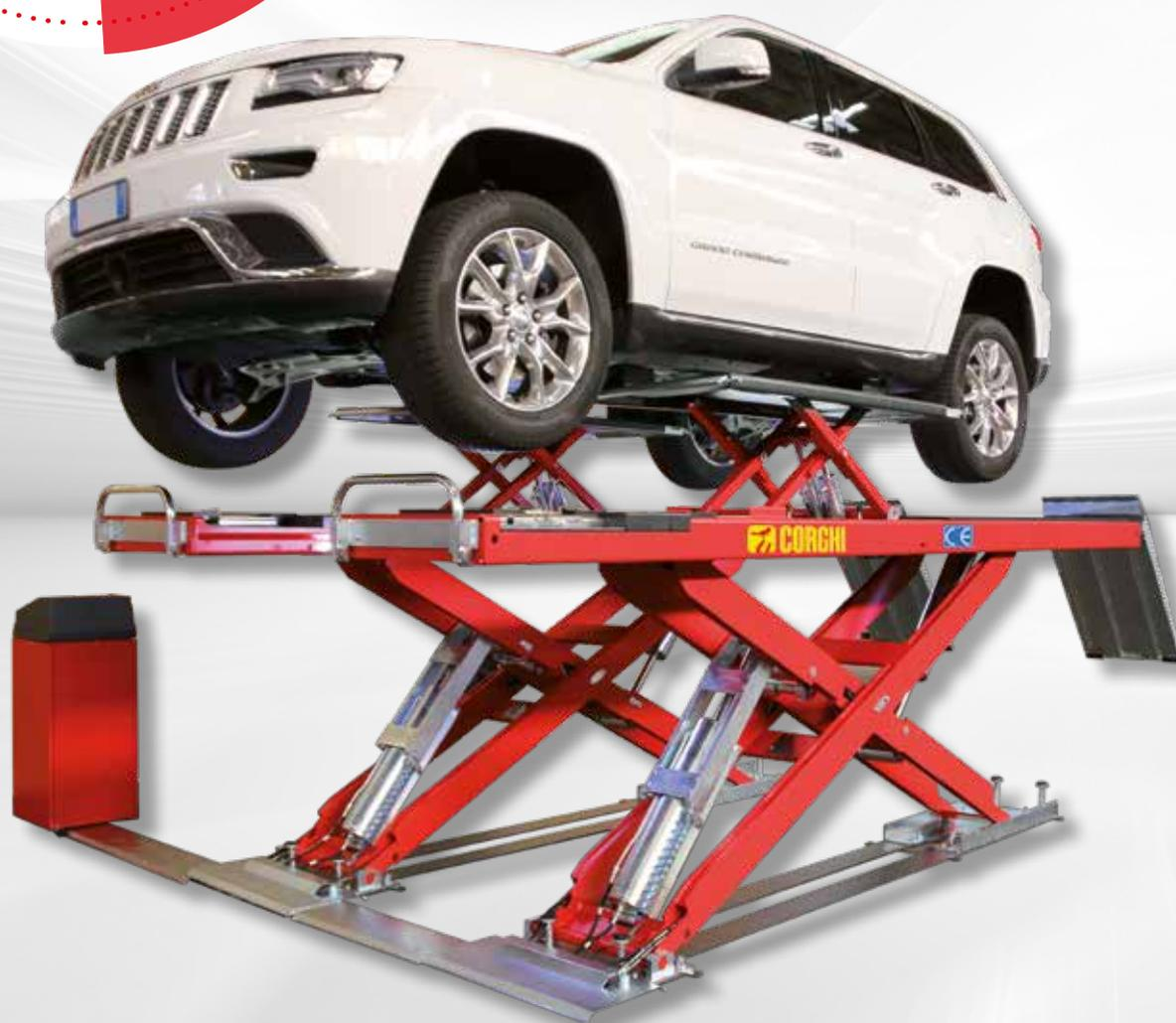
**Pont élévateur à ciseaux électrohydraulique à prise sous roues, pour le contrôle de géométrie «CT»**
