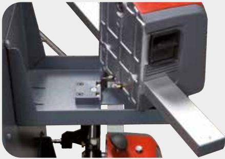
**1** **CCD-Messköpfe** in den Versionen Wireless oder mit Kabel verfügbar. Wireless-Version mit Industrie- Funktechnologie 2,4 GHz. Aufladen der Batterien am Geräteschrank mit montiertem Bügel.
