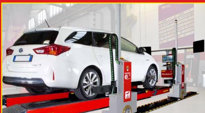
2 Ricerca ponte\* - Ricerca ruota - Misura ruota
