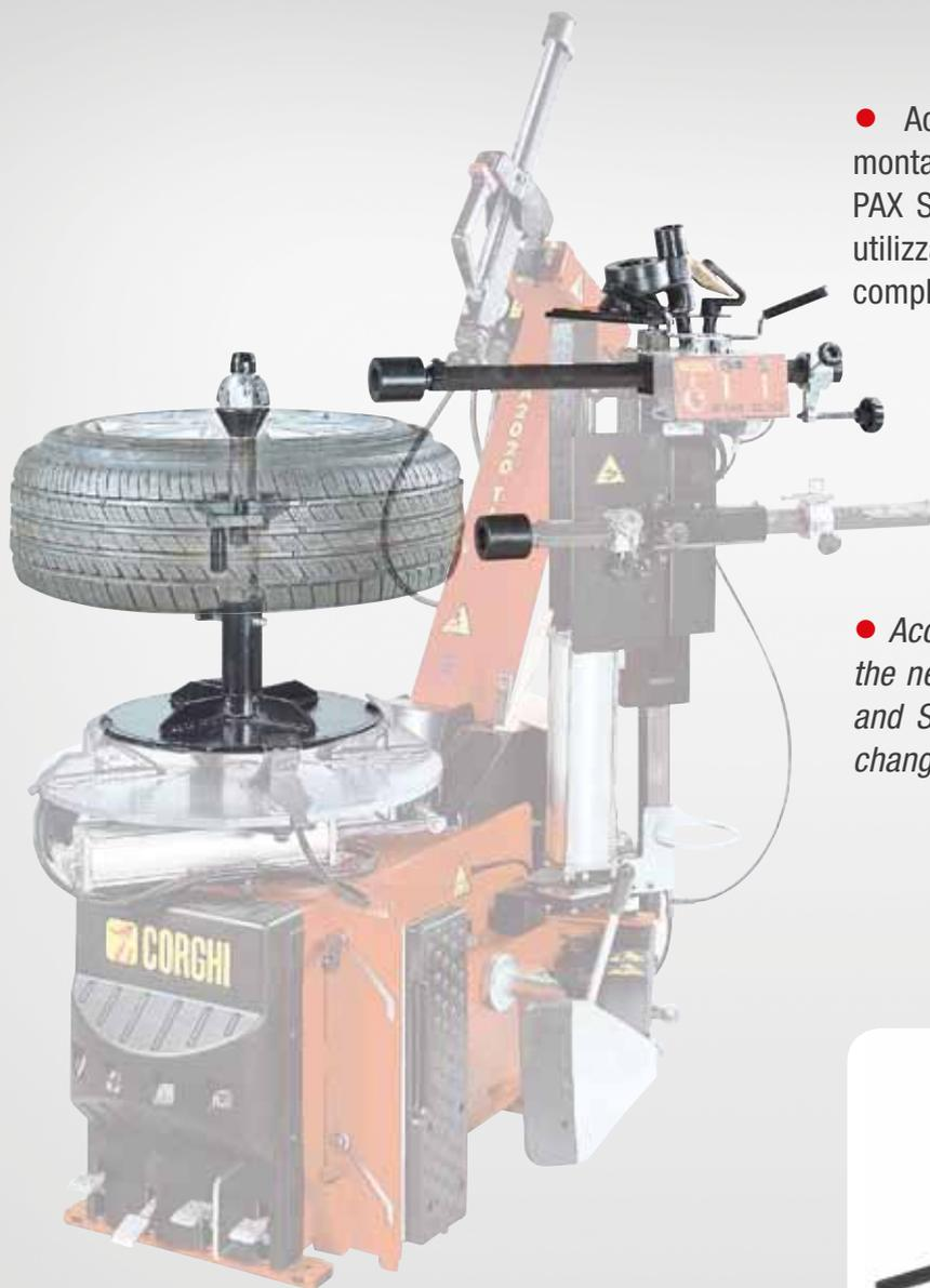
● Accessorio per il corretto smontaggio e montaggio dei nuovi pneumatici RUN FLAT PAX SYSTEM per ruote di autovetture e SUV, utilizzabile esclusivamente su smontagomme completi di stallonatore SP2000.
